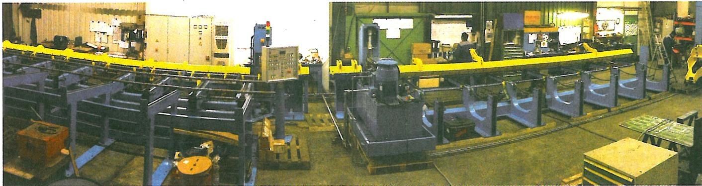
Die gesamte Anlage zum Richten von Stabstahl, bevor sie demontiert und auf den Weg nach Freital gebracht wurde.
