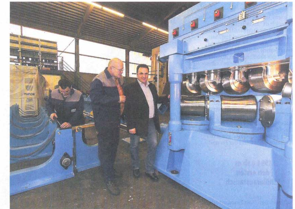
Bülent Kaya, Michael Karojet und Betriebsleiter Konstantin Althajmer (v.l.) vor einer gebrauchten Kieserling „Neun-Walzen-Richtmaschine“, die komplett generalüberholt wurde und nun nach Österreich geliefert wird. FOTO: ANJA TINTER
